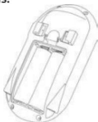
Asegúrese de que las baterías estén insertadas correctamente como se muestra en el compartimento de la batería y que el lazo queda detrás de ellas.
